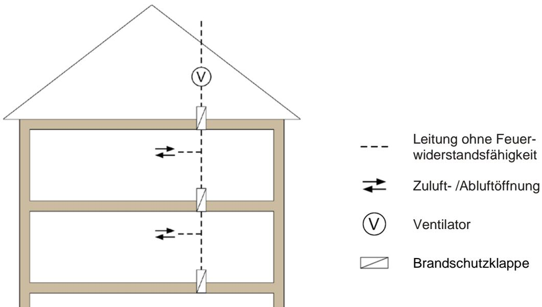
**Bild 2.2: Schachtlösung**
