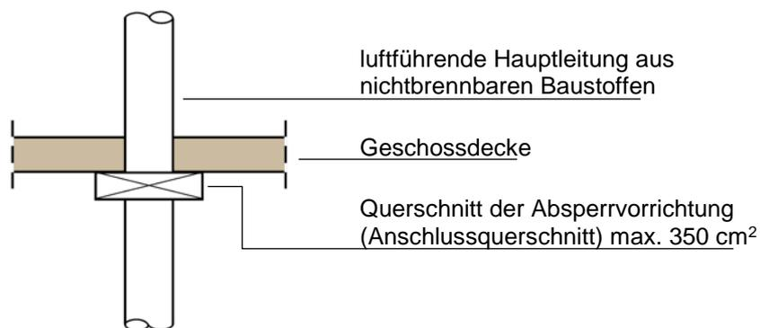
6.3: Schachtlösung für Lüftungsanlagen nach DIN 18017-3:2009-09
