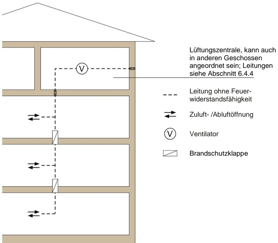
**Bild 1.2: Schachtlösung**
