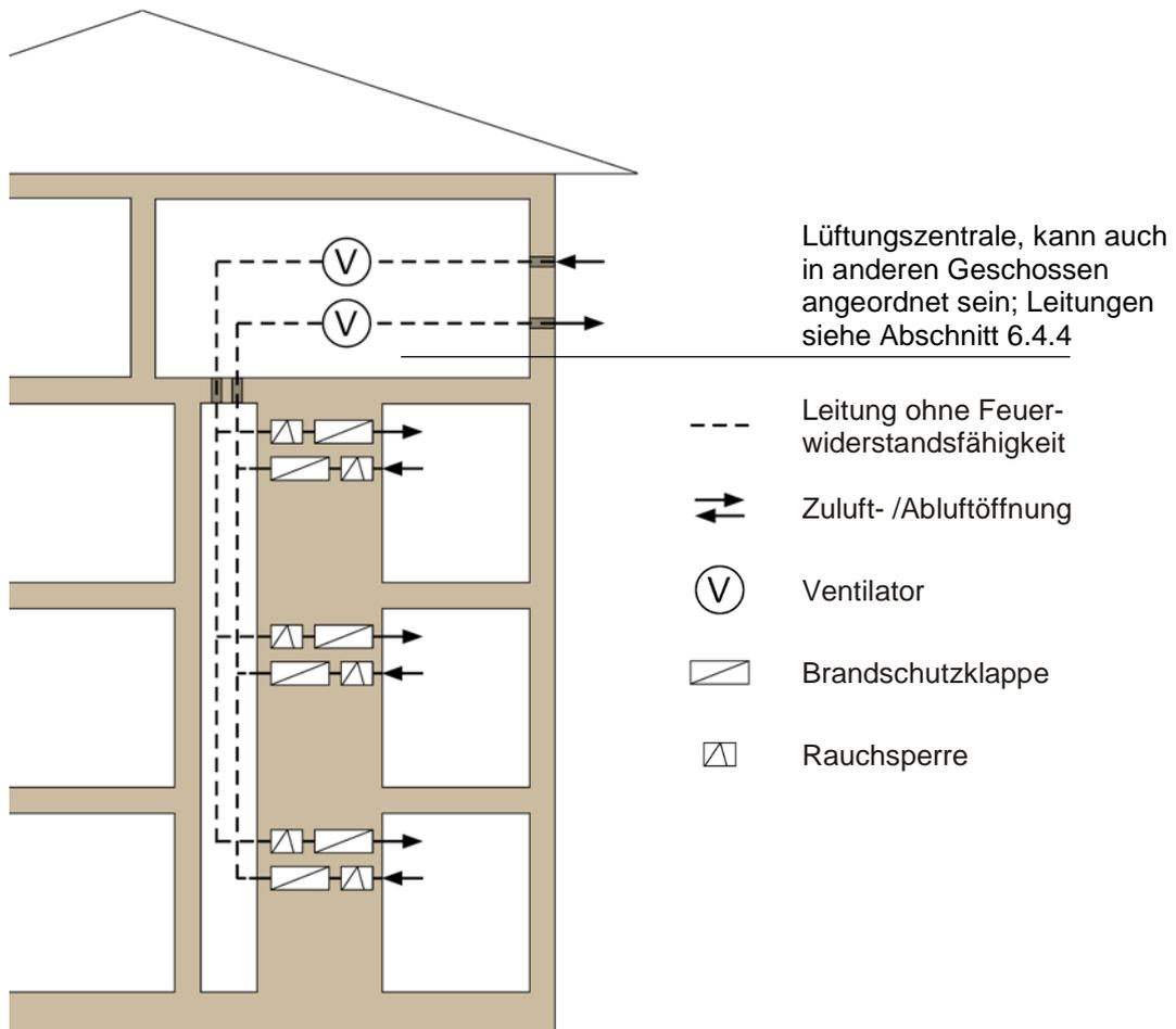
**Bild 6.2: Beispiel für Schottlösung für Lüftungsanlagen nach DIN 18017- 3:2009-09 maximaler Anschlussquerschnitt der Absperrvorrichtungen: 350 cm<sup>2</sup>**
