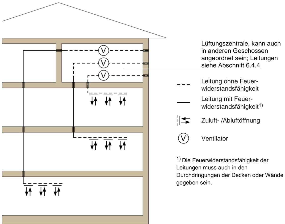
**Bild 1.4: Lüftungsanlagen mit getrennten Hauptleitungen und gemeinsamer Außenluft- oder Fortluftleitung mit Rauchschutz**
